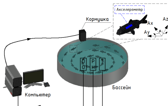
Рисунок 3. Схема, показывающая структуру системы распознавания поведения рыб при кормлении на основе других датчиков
