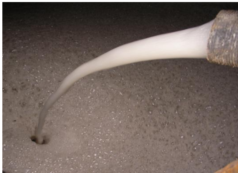
Рисунок 3.14 – Поверхностная пена с «жесткой» структурой и активным веществом в бункере-накопителе отжатой жидкости
