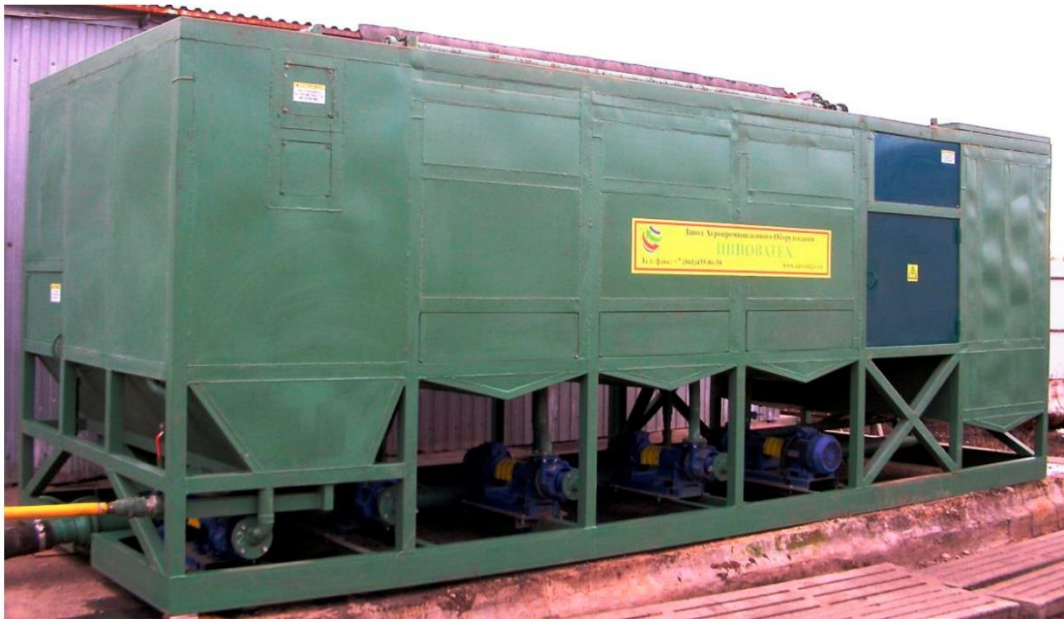
Рис. 3. Станция очистки навозных стоков
