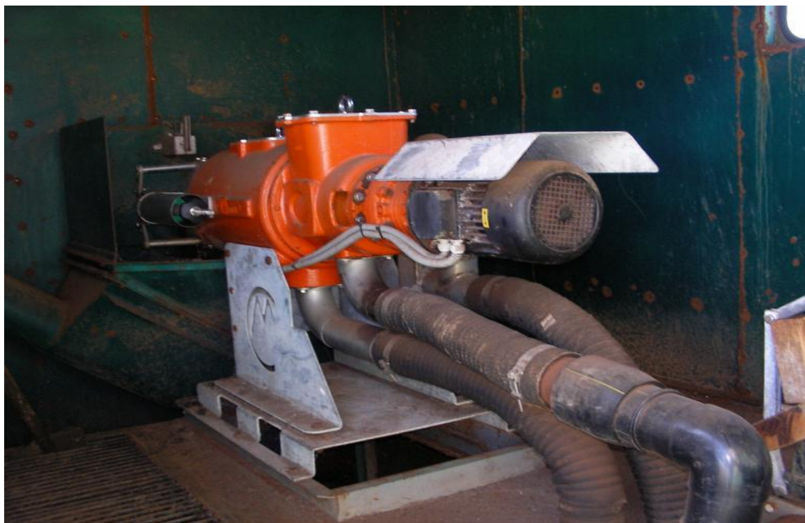
Рисунок 3.7 – Шнековый сепаратор с размером ячейки сита 0,5 мм
