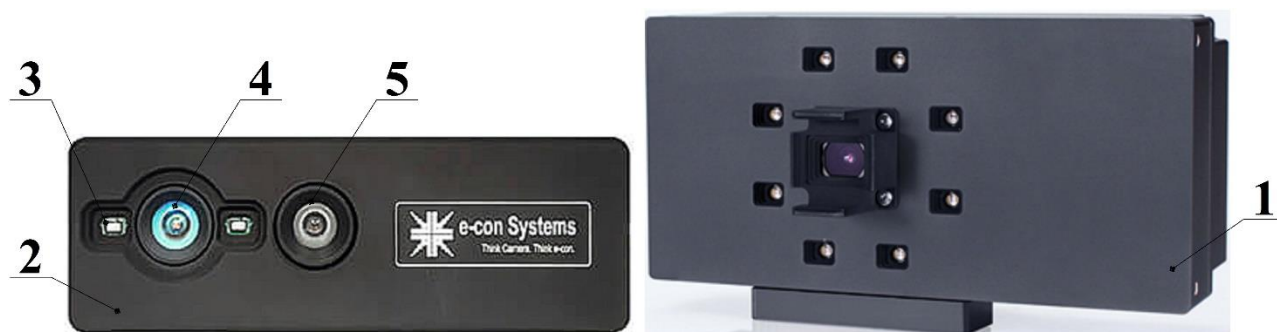
1 – 3D TOF камера, 2 – 3D RGB-D камера с TOF датчиком глубины, 3 – источник света, 4 – TOF сенсор, 5 – RGB камера.
