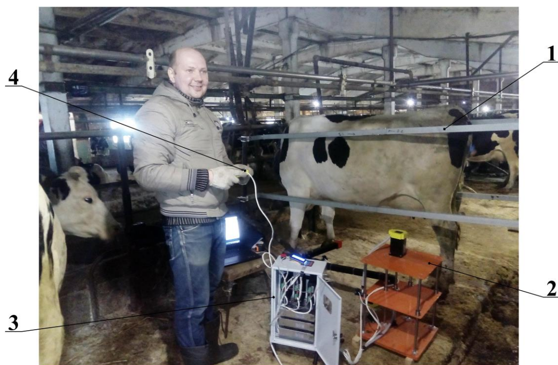
1 – станок; 2 – манипулятор; 3 – блок управления; 4 – пульт для ручного управления манипулятором.
