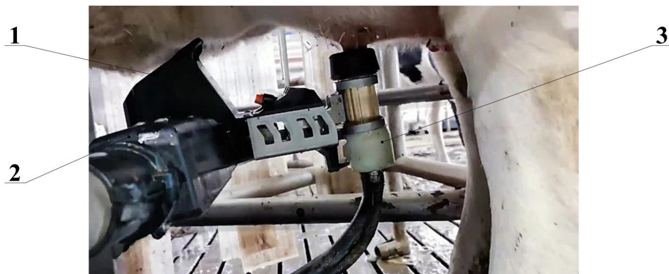
1 – 3D камера системы машинного зрения, 2 – манипулятор, 3 – стакан для проведения преддоильной подготовки.
