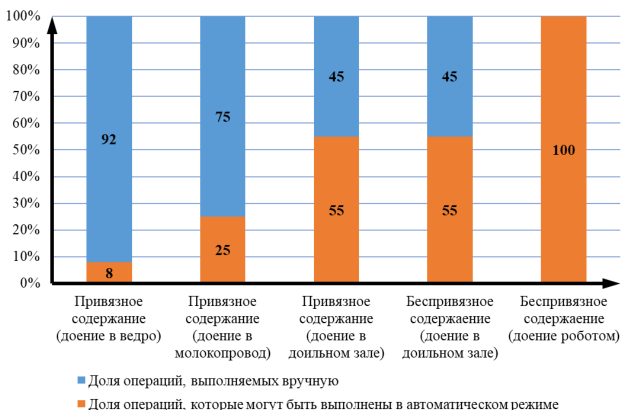
Рисунок 1.1 – Доля операций, выполняемых в ручную и в автоматическом режиме при различных способах содержания коров.
