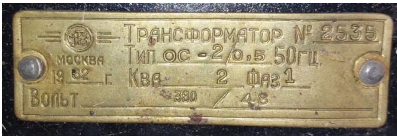
Рисунок 4.7 – Данные трансформатора ОС-2/0,5 №2535
