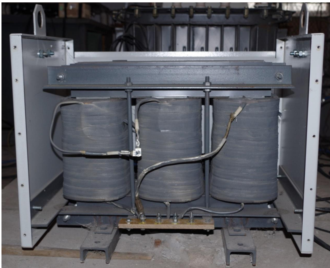
Рисунок 4.1 – Сухой трансформатор ТС-1 (ТС-2). Защитный кожух частично снят для наглядности
