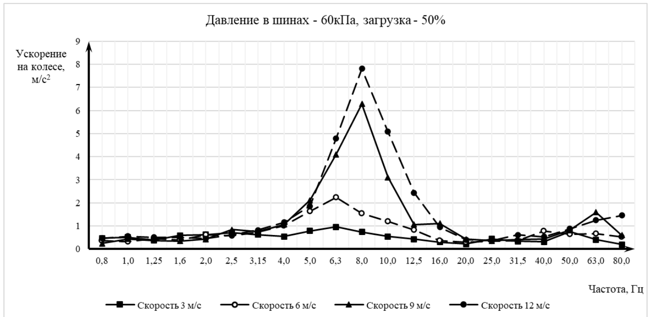
Рисунок 7 – Среднеквадратичные ускорения на оси колеса при проезде единичной трапецевидной неровности: загрузка 50%, давление воздуха в шинах – 60 кПа.
