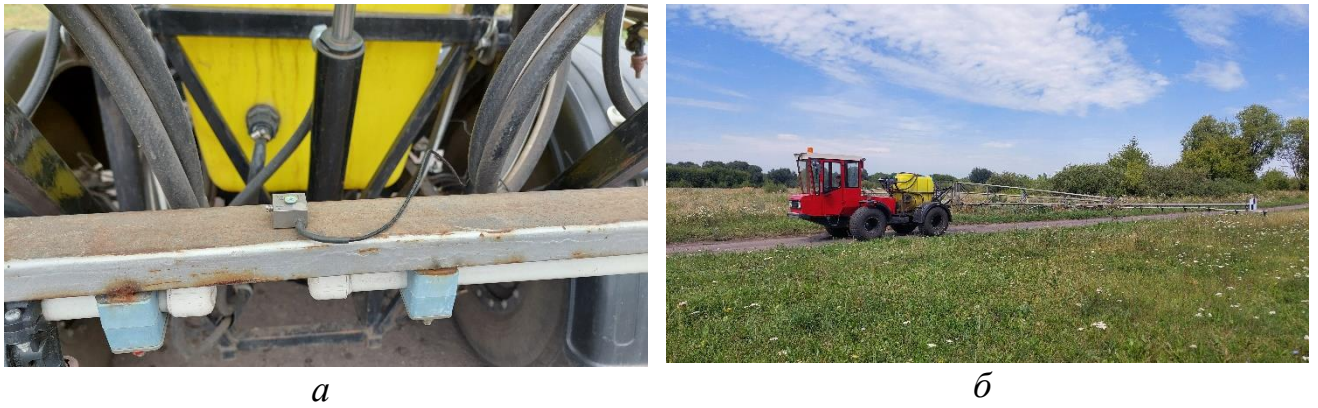
Рисунок 3.13 – Проведение лабораторно-полевых исследований виброн нагруженности штанг опрыскивателя МЭС-600: а – место крепления вибропреобразователя АР38Р; б – фрагмент с объектом исследования с испытательного участка.
