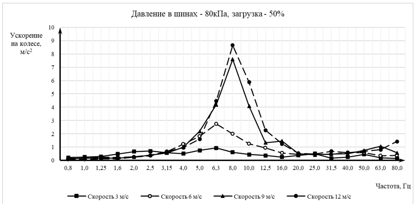
Рисунок 8 – Среднеквадратичные ускорения на оси колеса при проезде единичной трапецевидной неровности: загрузка 50%, давление воздуха в шинах – 80 кПа.
