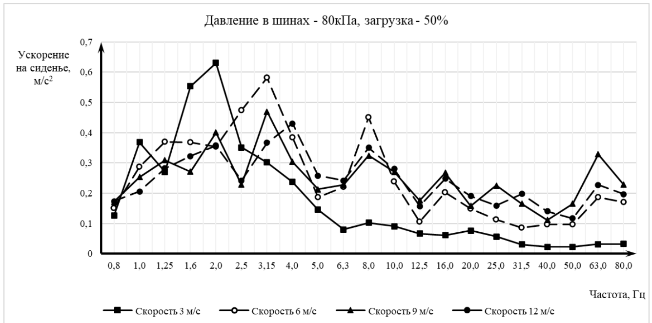
Рисунок 32 – Среднеквадратичные ускорения на сиденье при проезде единичной трапецевидной неровности: загрузка 50%, давление воздуха в шинах – 80 кПа.
