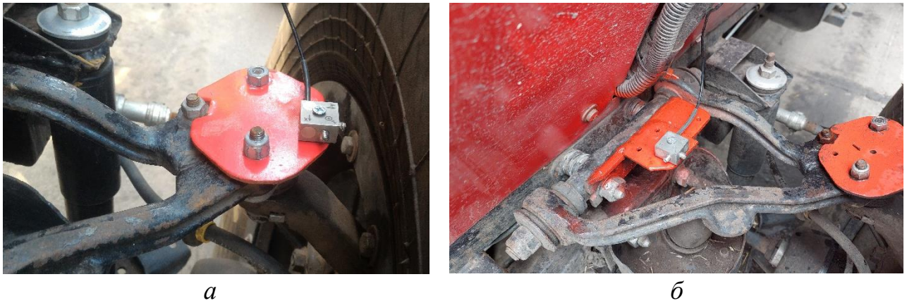
Рисунок 3.11 – Точки фиксации вибро-преобразователя АР38Р: а – на кулаке колеса; б – на раме у переднего левого колеса.
