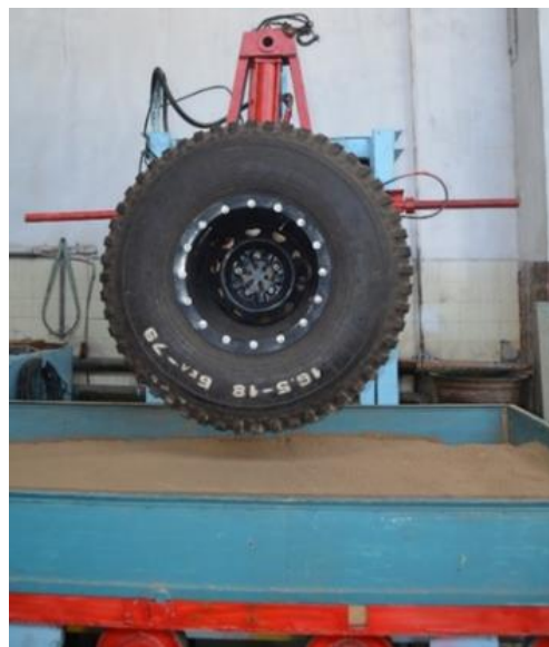
Рисунок 3.2 – Универсальный шинный испытательный стенд с шиной 1020x420-18
