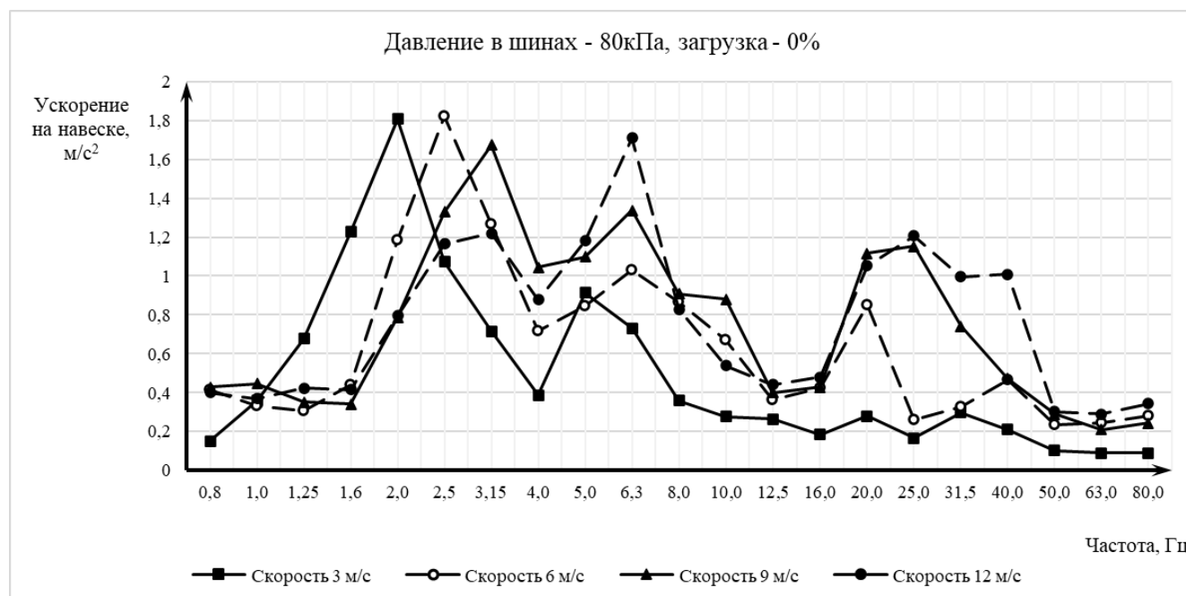
Рисунок 40 – Среднеквадратичные ускорения на навеске при проезде единичной трапецевидной неровности: загрузка 0%, давление воздуха в шинах – 80 кПа.
