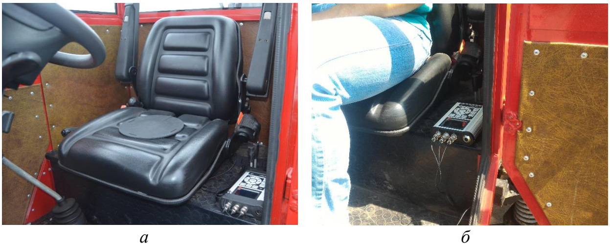
Рисунок 3.12 – Места установки измерительно-регистрающей аппаратуры: а – полужесткий установочный диск с вибропреобразователем АР38Р; б – блок измерительный с анализатором вибрации.
