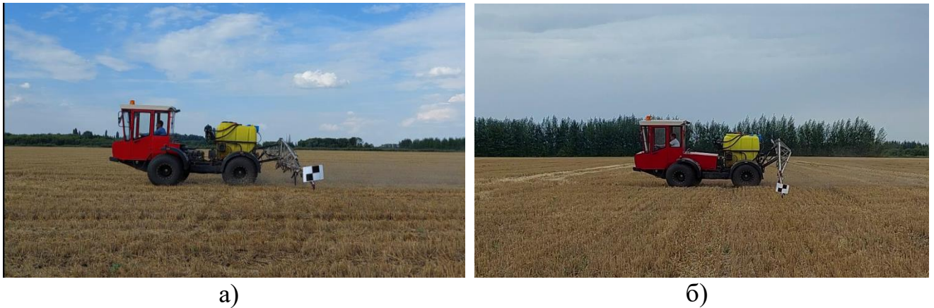
Рисунок 3.16 – Фрагмент проведения полевых исследований вибронегруженности МЭС-600 при движении по естественному агрофону
