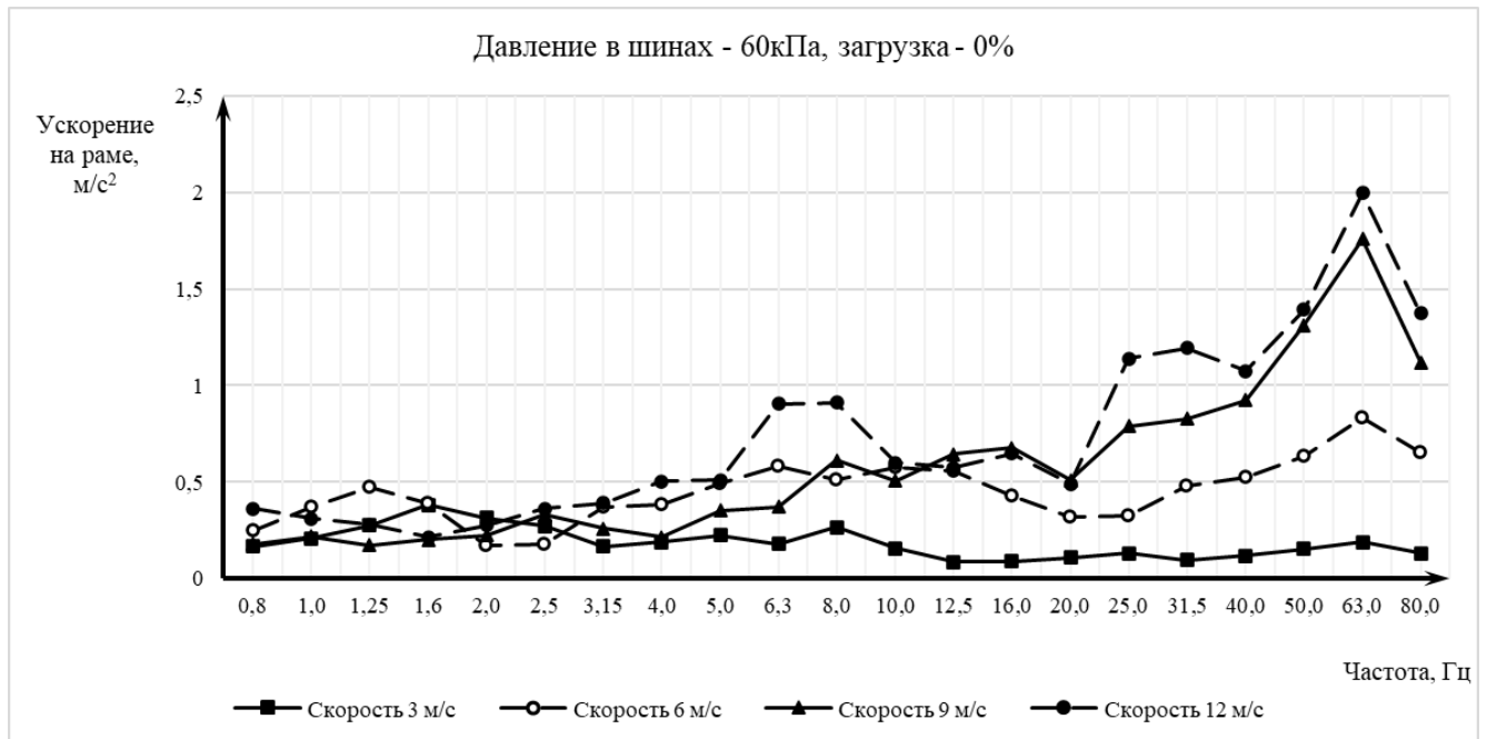
Рисунок 15 – Среднеквадратичные ускорения на раме при проезде единичной трапецевидной неровности: загрузка 0%, давление воздуха в шинах – 60 кПа.
