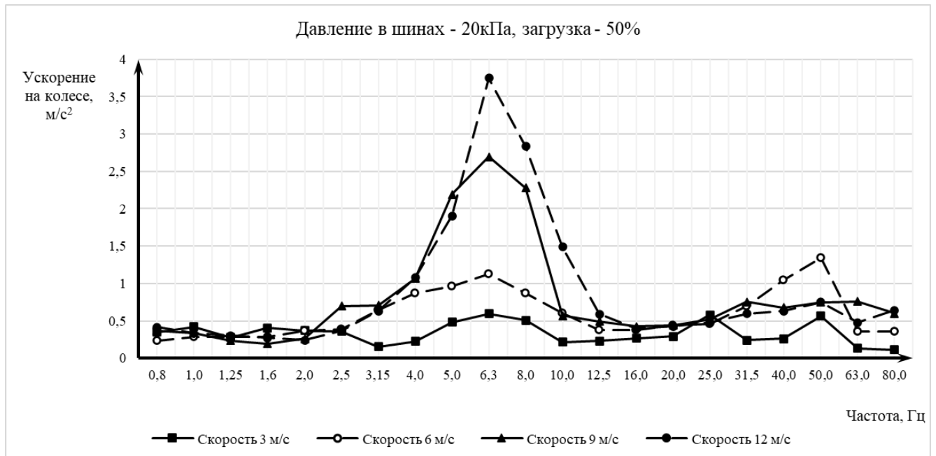
Рисунок 5 – Среднеквадратичные ускорения на оси колеса при проезде единичной трапецевидной неровности: загрузка 50%, давление воздуха в шинах – 20 кПа.
