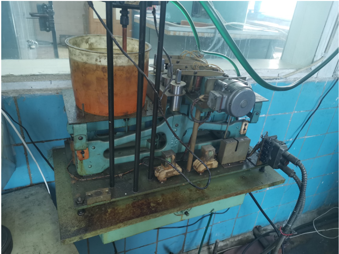
Рис. 3.11. Вид на весовое устройство расходомера топлива
