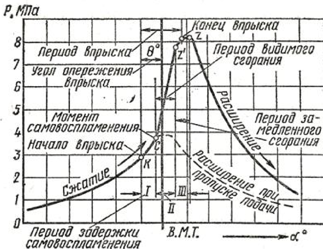
Рис. 2.3. Типичная диаграмма изменения давления в цилиндре дизеля в процессе сгорания топлива
