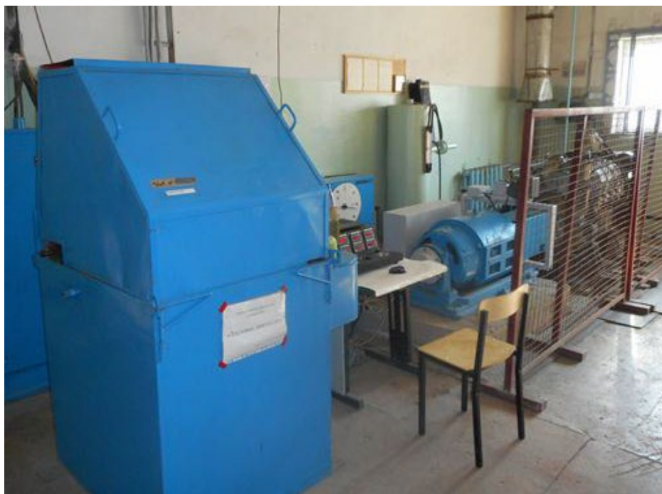
Рисунок 1.1 – Обкаточно-тормозной стенд КИ-5540М с двигателем КАМАЗ-740
