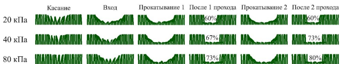
Рисунок 5 – Результаты воздействия шин сверхнизкого давления при двухкратном проходе
