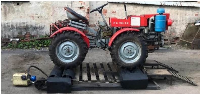
Рис. 6. Обкаточно-тормозной стенд с беговыми барабанами
