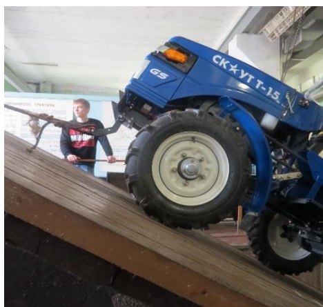
Рис. 1. Стендовые испытания минитракторов:
