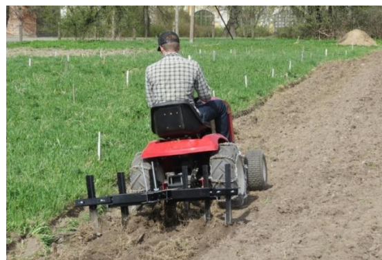
Рис. 2. Эксплуатационные испытания минитракторов: а – определение радиуса поворота минитрактора МИТРАКС; б – культивация вспаханного поля минитрактором МИТРАКС
