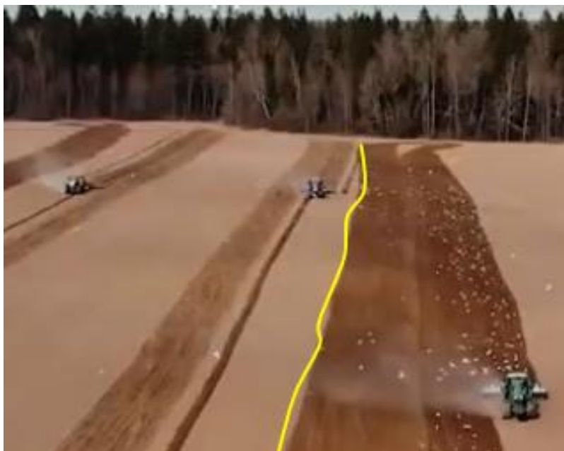
Рис. 2. Криволинейное движение агрегатов по полю при ручном управлении
