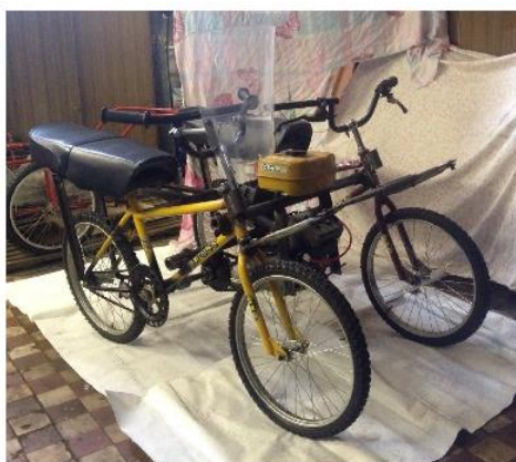
Рис. 9. Велоцикл конструкции АТТС: а – велоцикл; б – цепной дифференциал
