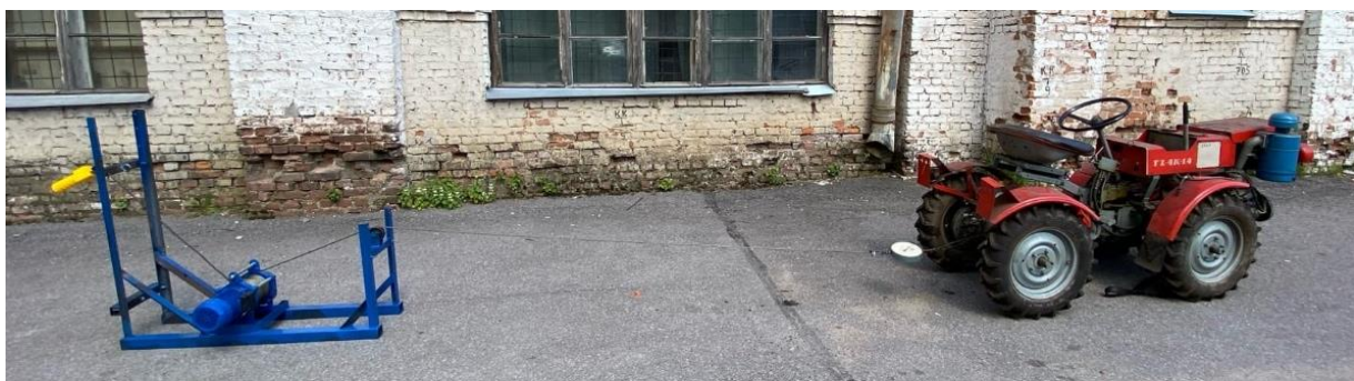
Рис. 7. Стенд для определения тягово-сцепных свойств минитракторов
