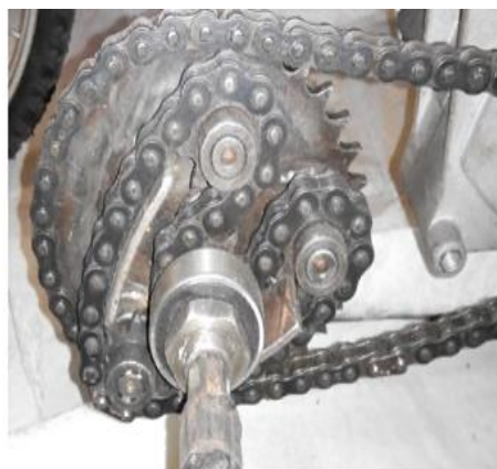
Рис. 9. Велоцикл конструкции АТТС: а – велоцикл; б – цепной дифференциал
